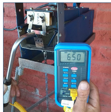
Pirómetro indicando la temperatura apropiada de la cuchilla de 650°C.
